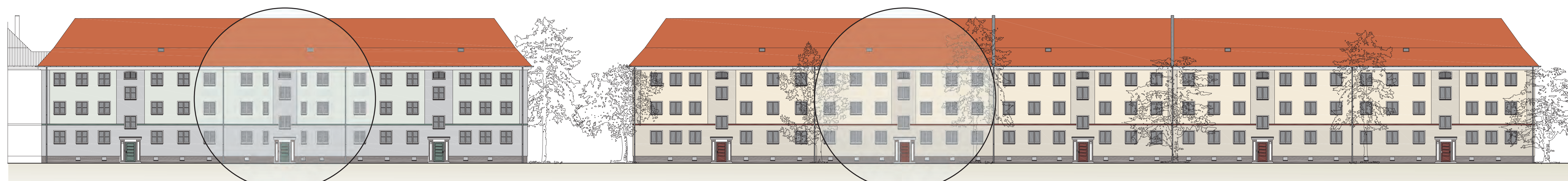
Farbkonzept Fassaden, Hauseingänge und Treppenhäuser in verschiedenen Kombinationen zur Individualisierung der Aufgänge und Wohneinheiten
