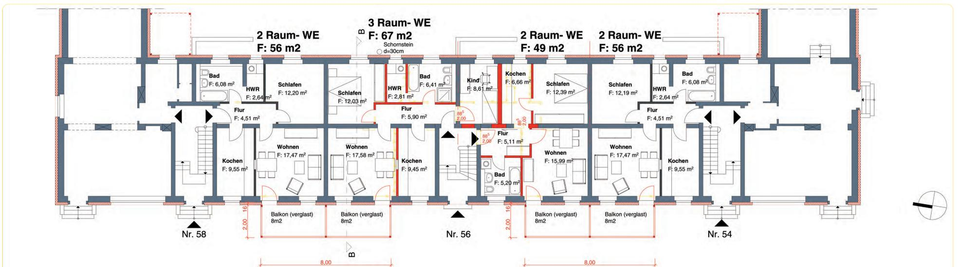
Anbau von Balkonen und Grundriss: Erdgeschoss
