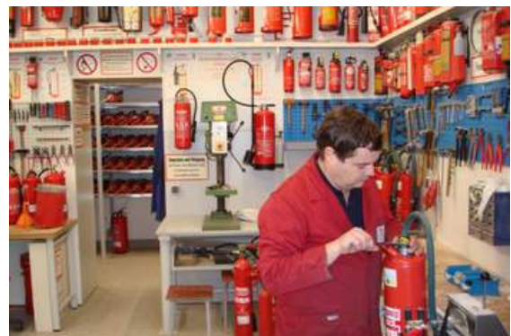
Prüfung eines Feuerlöschers
