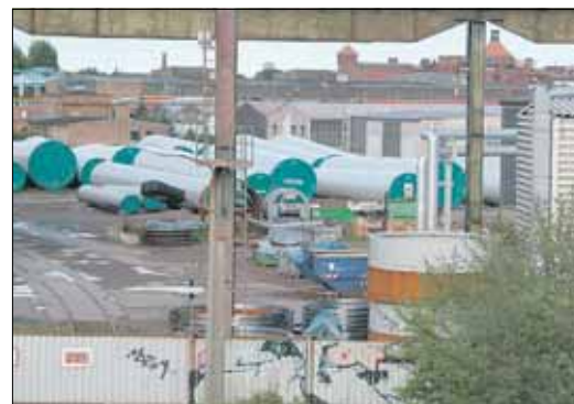
Hier wird die Technologie für die Energiewende hergestellt: GSD Großanlagen- und Maschinenbau, Standort Dessau; Produktion von Stahlrohrtürmen für Windkraftanlagen Foto: Brückner
