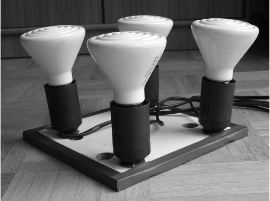
Abb. 1: Infrarotstrahler, Elstein, Typ IOT, 100 W (Foto: E. WILLING, 2010)
