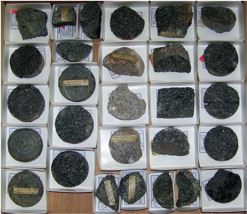
Abb. 4 Bohrkern der Bohrung Kochstedt 1/50 aus 255–273 m Tiefe, bestehend aus Biotitdiorit und Granitaplit (Sammlung des Museums für Naturkunde und Vorgeschichte Dessau, Foto: H. BÖTTCHER, 2010).
