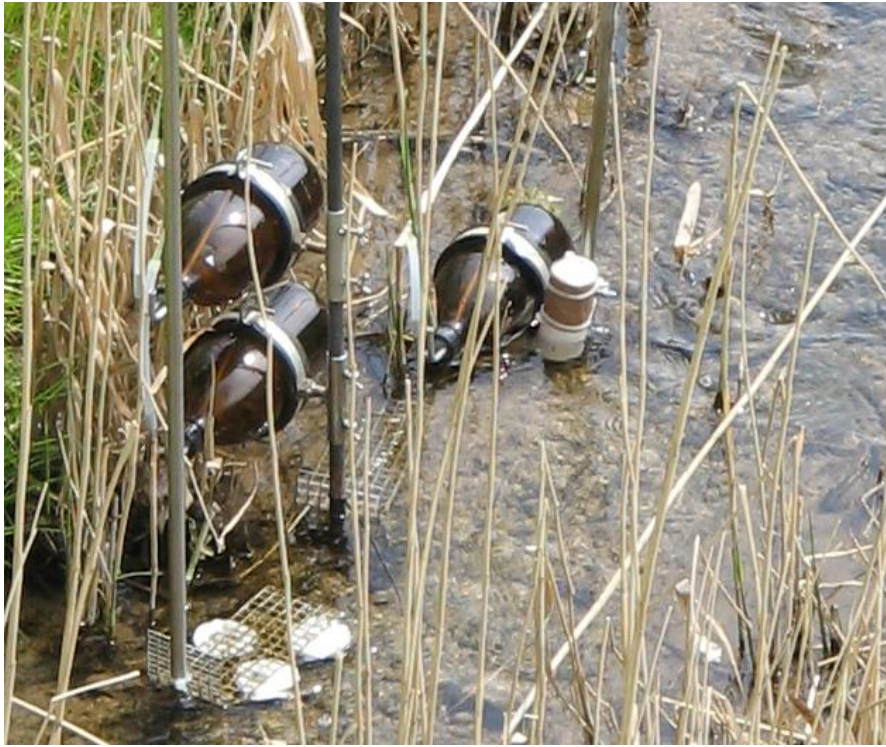
Abbildung 3: Beispiel für die Installation von Passivsammlern (Chemcatcher, unten), ereignisgesteuerte Probenehmer (EDS, Braunglasflaschen) und PFM (rechts von der hinteren Braunglasflasche)
