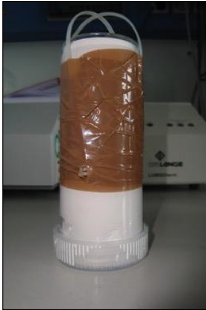
Abbildung 7: Gipskartuschen, präpariert für Fixierung im Gewässer (links) und nach Ausbringung (rechts)
