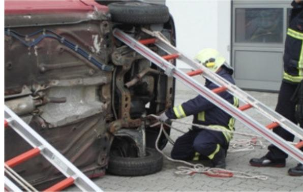
Sichern eines PKW mit Steckleiterteilen.
